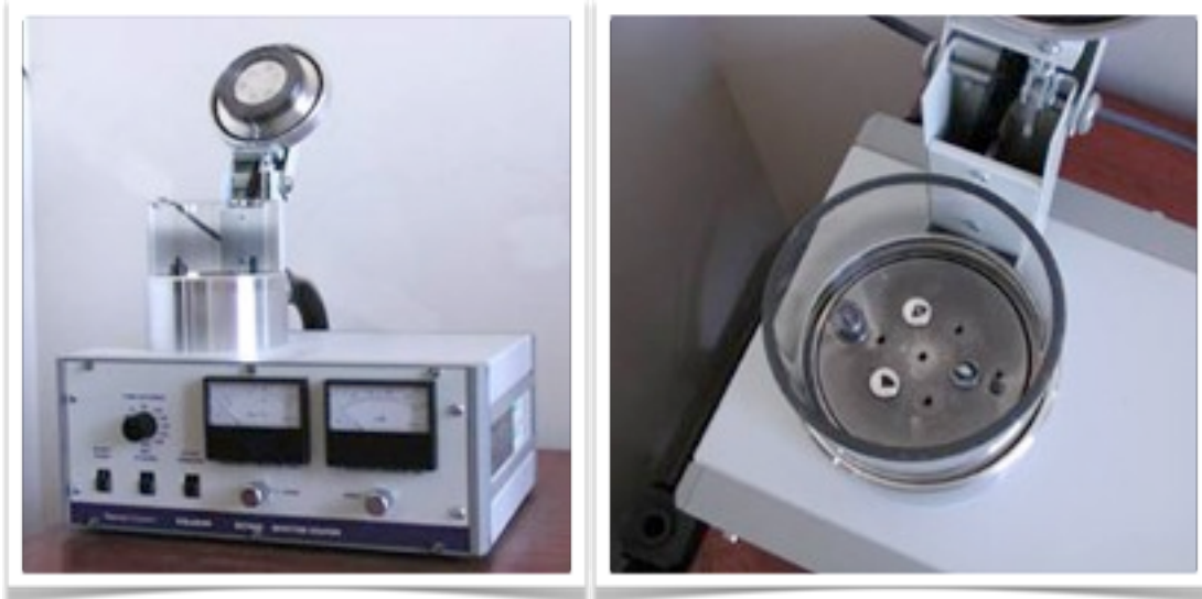
Figura VII.2. Izquierda: Metalizador. Derecha: cámara de metalizado con espacio para 7 soportes donde se observan 3 soportes en posición.
